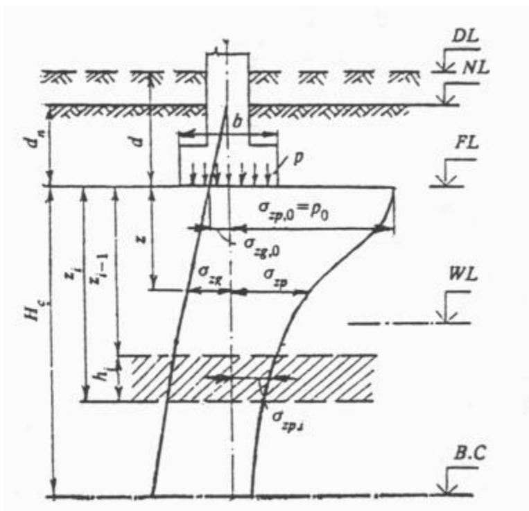
Рис. 1. Схема распределения вертикальных напряжений в линейно-деформируемом полупространстве
